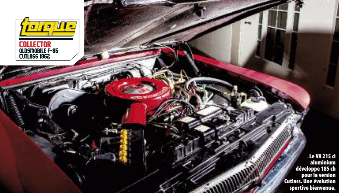
Sous le filtre à air, un carburateur Rochester quadruple corps.
