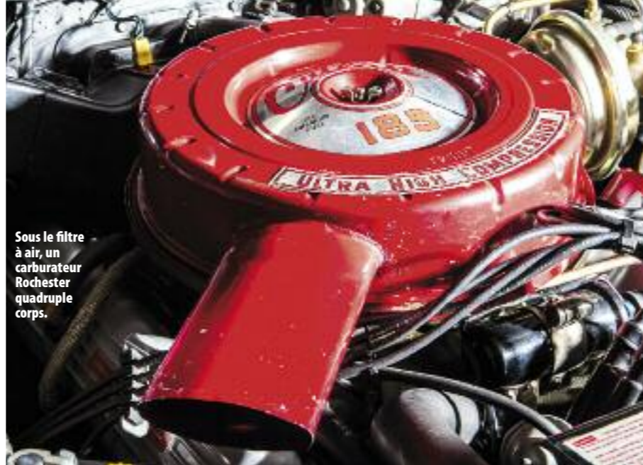
Le V8 215 ci aluminium développe 185 ch pour la version Cutlass. Une évolution sportive bienvenue.
